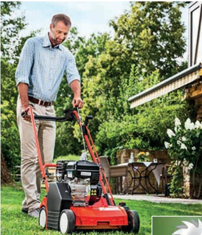
Durch das Vertikutieren werden Moos, Unkraut und Rasenfilz entfernt. Achten Sie dabei darauf, dass das Vertikutiermesser (Bild rechts) nicht tiefer als 2–3 mm in den Boden eindringt, da ansonsten die Graswurzeln beschädigt werden können.
