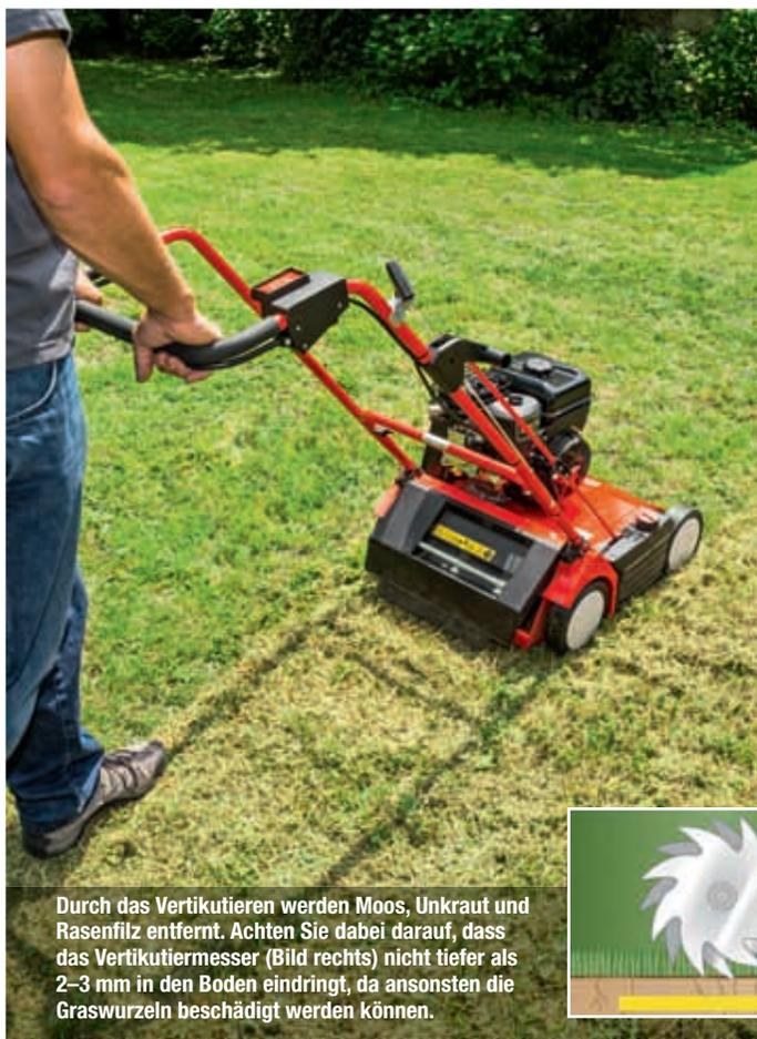
Durch das Vertikutieren werden Moos, Unkraut und Rasenfilz entfernt. Achten Sie dabei darauf, dass das Vertikutiermesser (Bild rechts) nicht tiefer als 2–3 mm in den Boden eindringt, da ansonsten die Graswurzeln beschädigt werden können.
